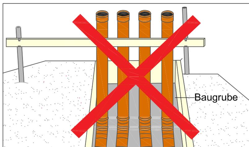
Herkömmliche bisherige Leerrohre, z.B. KG Rohre, Installationsrohre oder ähnliche Rohre sind als Hauseinführung nicht mehr zugelassen.
