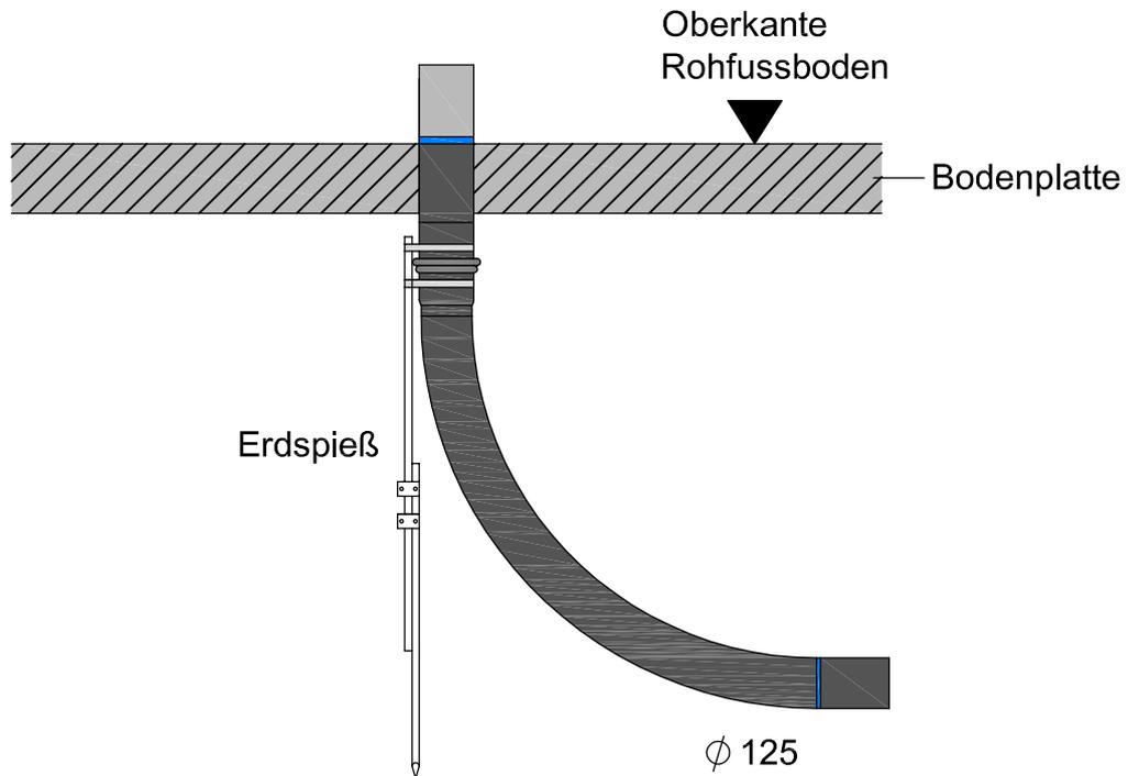
Die anerkannten Regeln der Technik schreiben die bauseitige Installation von zertifizierten gas-und wasserdichten Hauseinführungen vor. ( DIN 18322 und DVGW VP601)
